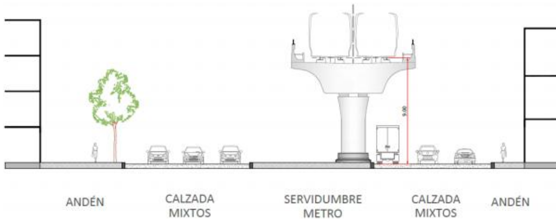
Figura 6.30 Sección particular Av. Villavicencio con inserción excéntrica puntualmente – Fuente: SYSTRA
